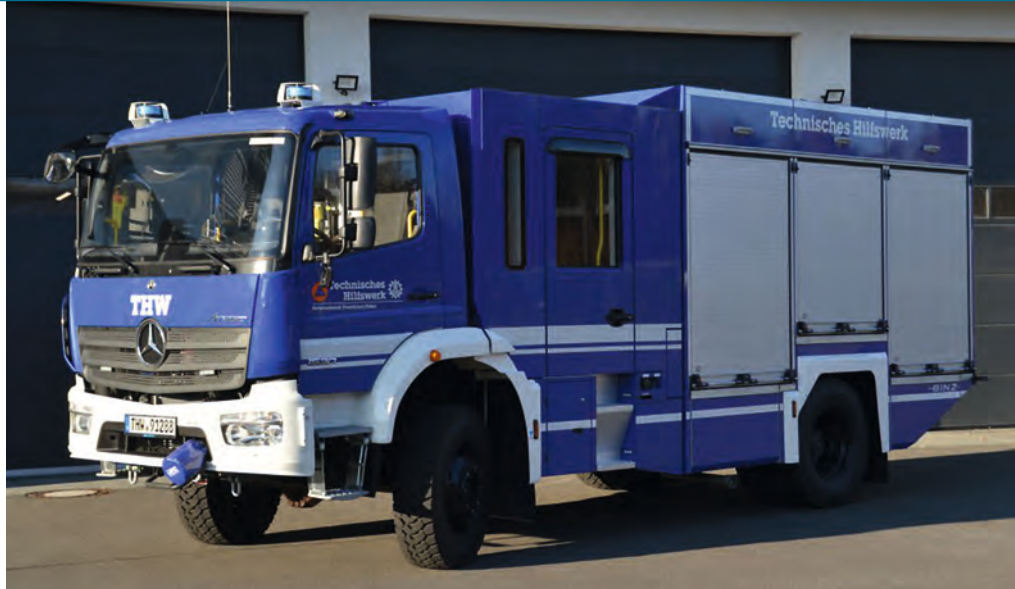
Eine Werkzeugkiste auf Rädern: Der THW-Gerätekraftwagen transportiert bis zu neun Helferinnen und Helfer sowie Klein-, Groß- und Spezialwerkzeug. Er besitzt einen Allradantrieb sowie eine Seilwinde. (Quelle: THW/Andy Schmiedichen)
