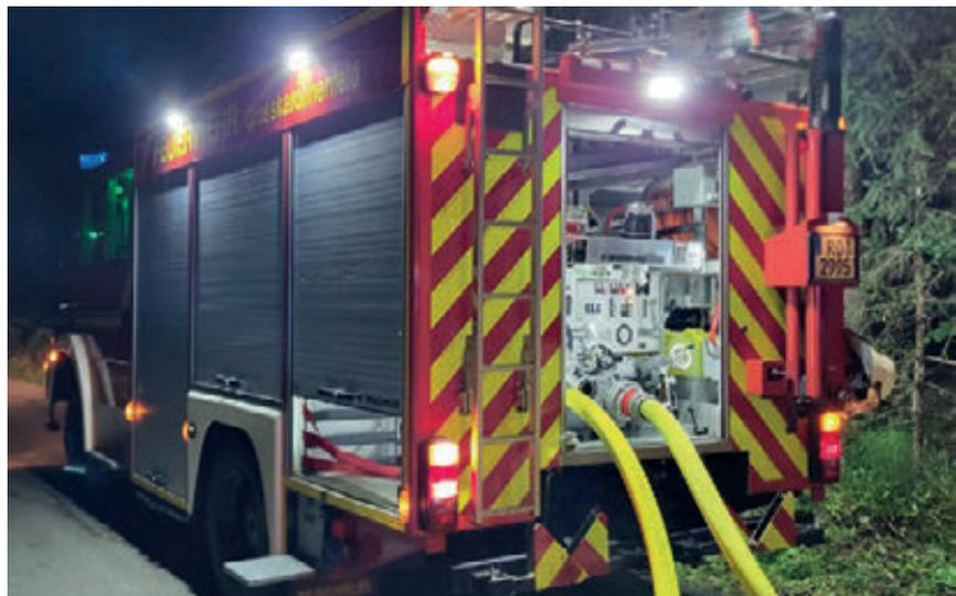
zu steuern. Desweiteren wird ein optisches Signal ausgegeben, wenn die Fahrzeug-Batterie einen niedrigen Stand erreicht, denn die Umfeldbeleuchtung fängt an aufzublitzen. Beim letzten Schwellenwert wird dann der Rückfahr-Warntonegeber auch akustisch aktiv, sodass immer gewährleistet ist, dass die Batterie immer im Stande ist, das Fahrzeug noch zu starten.
