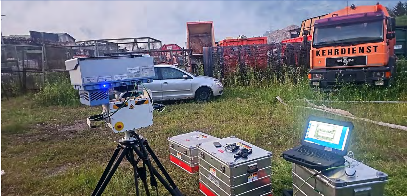
Messungen der Gaswolke an der Einsatzstelle. (Quelle: ATF München)
