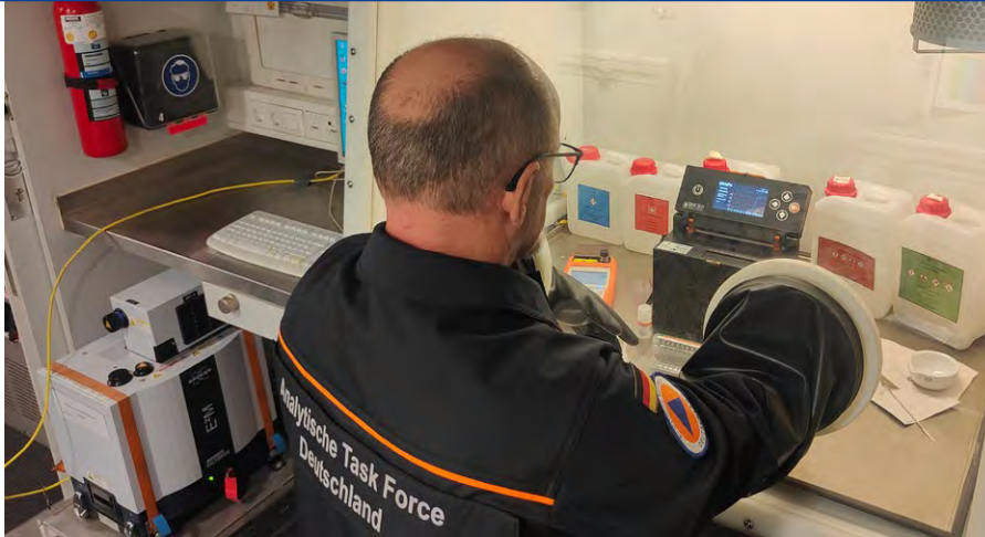
Mitarbeiter der ATF Hamburg bei der Bedienung des Razor Ex (Nachweisgerät für biologische Agenzien) im Messcontainer (nachgestelltes Bild). (Quelle: ATF Hamburg)
