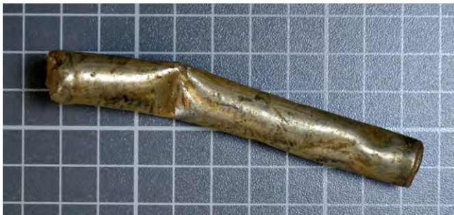
Nuklear-forensische Untersuchung: Fotodokumentation einer im Metallschrott sichergestellten Cobalt-60-Quelle (Raster mit 1 cm Kantenlänge). (Quelle: BfS)
